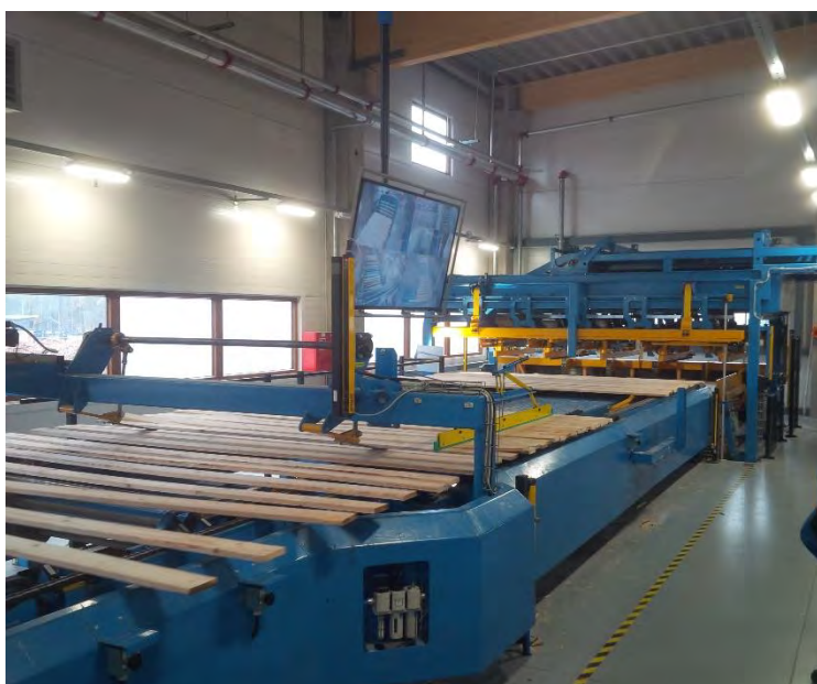
Рисунок 7: Укладчик досок с автоматическим управлением ручкой
